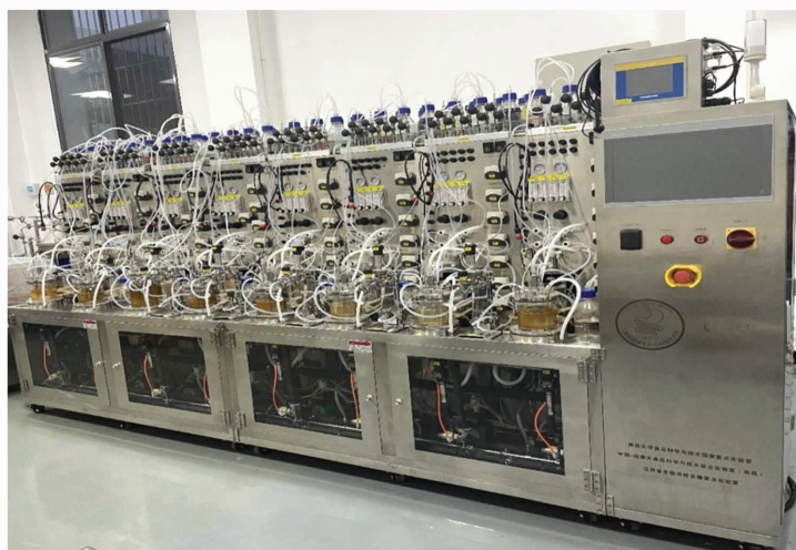
图4 全自动模拟人体胃肠道系统装置实物图
