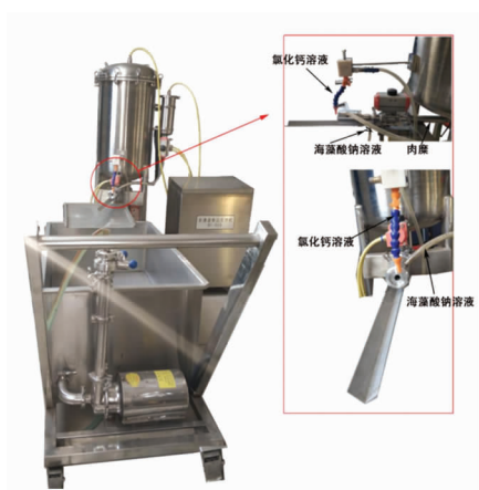
图 5 以海藻酸钠为原料的共挤香肠加工装置示意图 [59]
