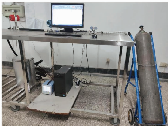
图7 干冰喷射速冻装置
