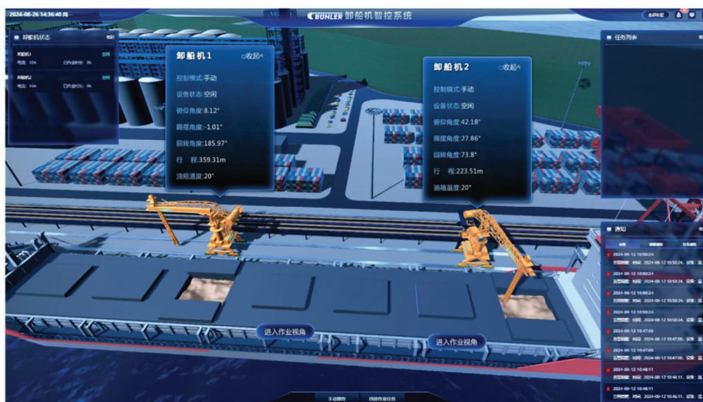
图 1 自动化连续式卸船机 3D 数字孪生效果图
